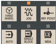
Setelah kembali ke mode JOG, gunakan tombol lintasan axis untuk menggerakkan mesin secara manual.
