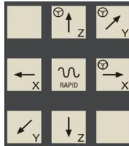
Tekan tombol "Handwheel" pada MCP dan posisikan alat pada lokasi X0 atau a pada benda kerja.
