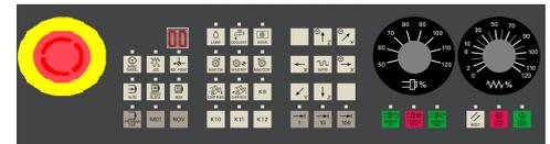
Panel kontrol mesin (MCP) 808D digunakan untuk memilih mode operasi mesin : JOG - MDA - AUTO
