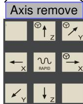
Panel Kontrol Mesin (MCP) 808D digunakan untuk mengontrol operasi manual axis. Mesin dapat digerakkan dengan tombol yang sesuai.
